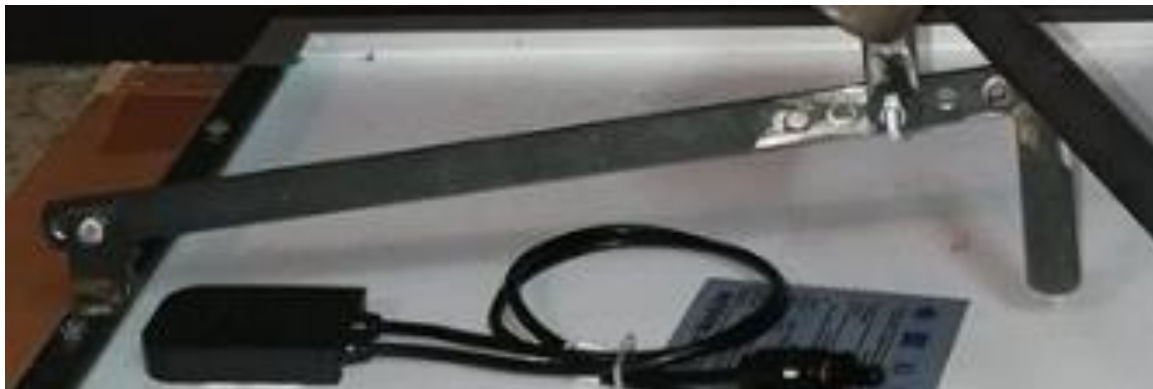
Slika 15: Mehanizem za ročno nastavljanje naklona
