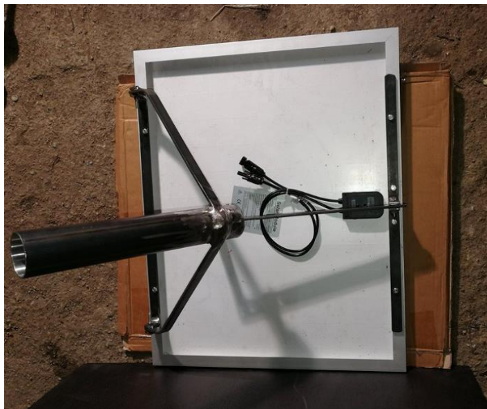
Slika 14: Izdelani nosilec za sončno celico
