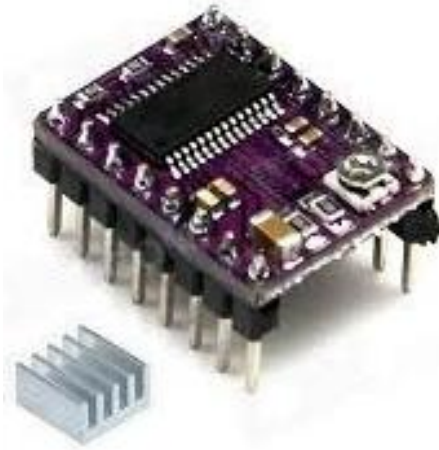
Slika 16: Gonilnik DVR 8825 s hladilnikom
