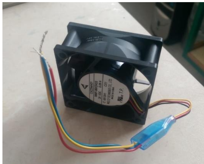
Slika 24: Ventilator za hlajenje gonilnika
