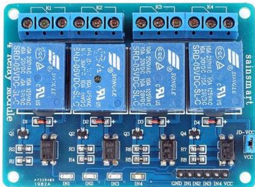
Slika 12- Priključki releja za povezavo na Raspberry Pi
