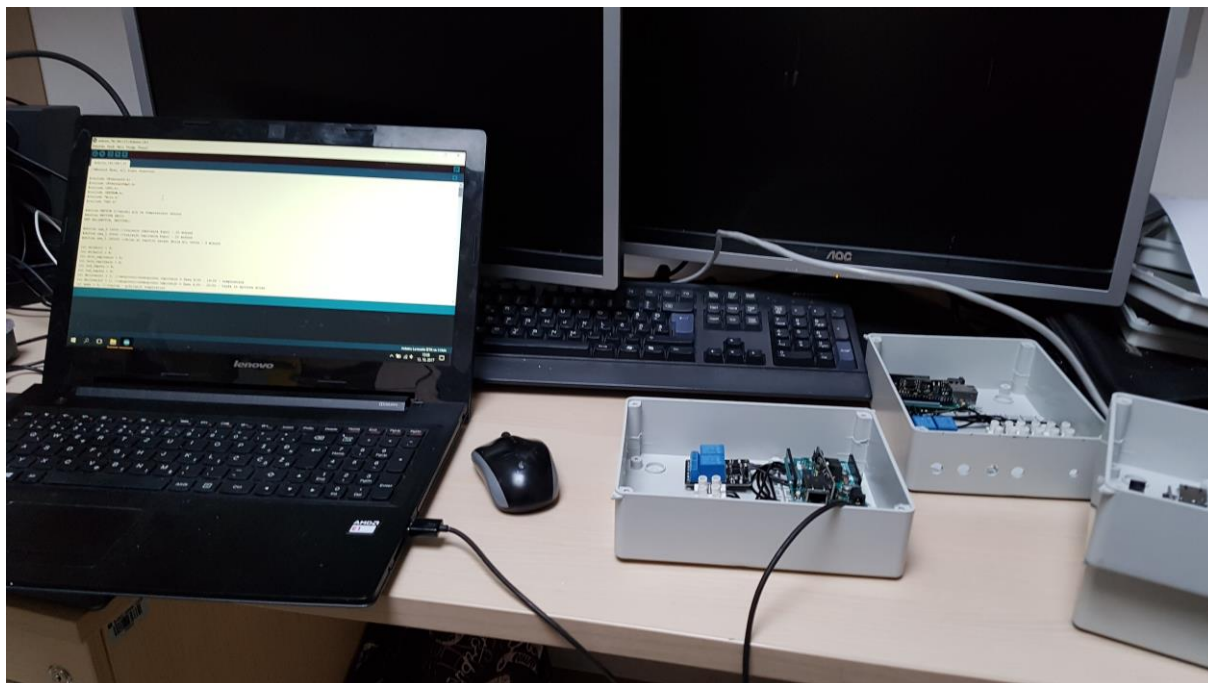
Slika 13: Nalaganje programa na mikrokontroler Arduino Leonardo ETH
