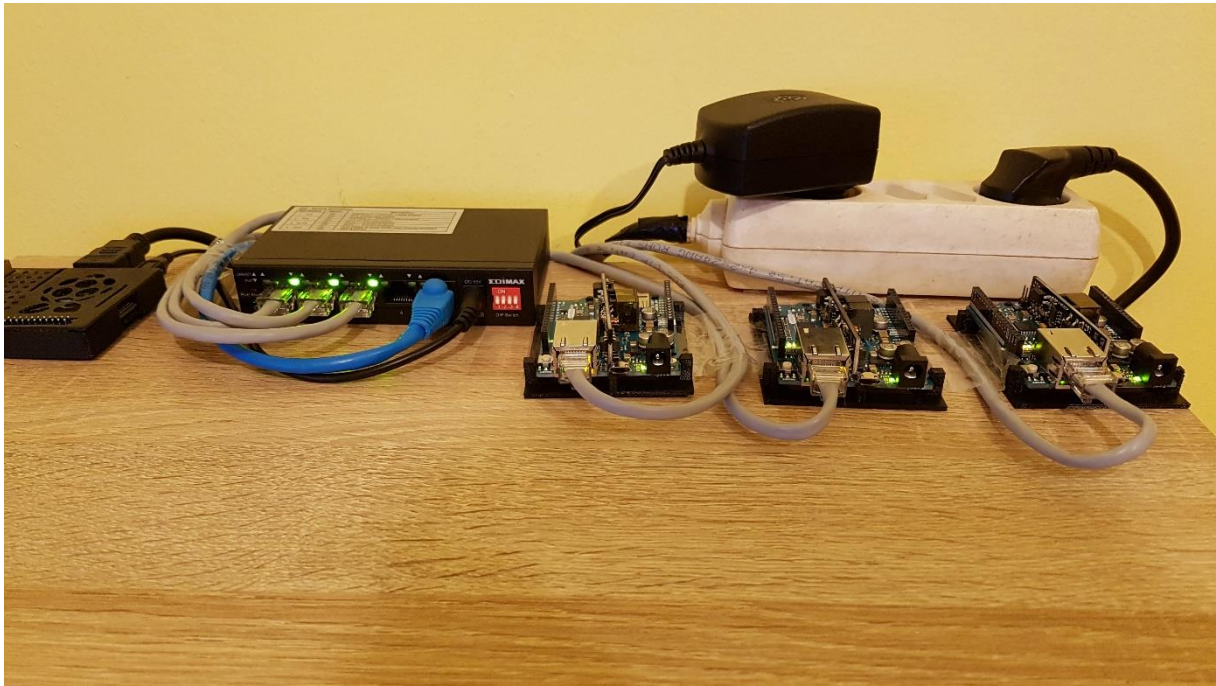
Slika 8: Omrežje mikrokontrolerov Arduino Leonardo ETH in Raspberry Pi
