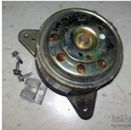
Slika 6: Motorček od avtomobilskega ventilatorja
