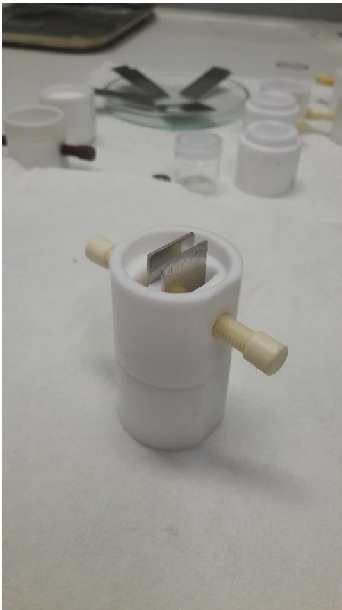
Slika 26: Sestavljena celica za merjenje prevodnosti
