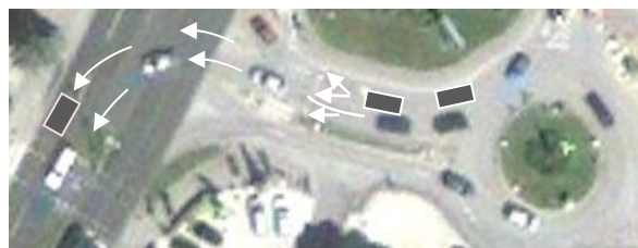
Slika št. 36: Primer simulacije novega načina zavijanja levega in desnega zavijalca
