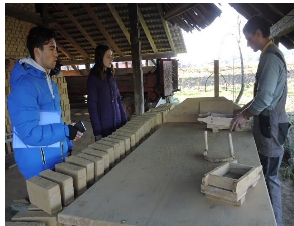
Slika 26: Prikaz postopka izdelave opeke (Čepin Tovornik, 2017)
