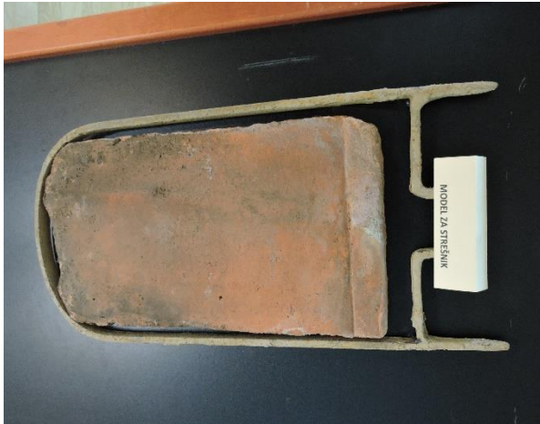
Slika 23: Model za strešnik (Čepin Tovornik, 2017)
