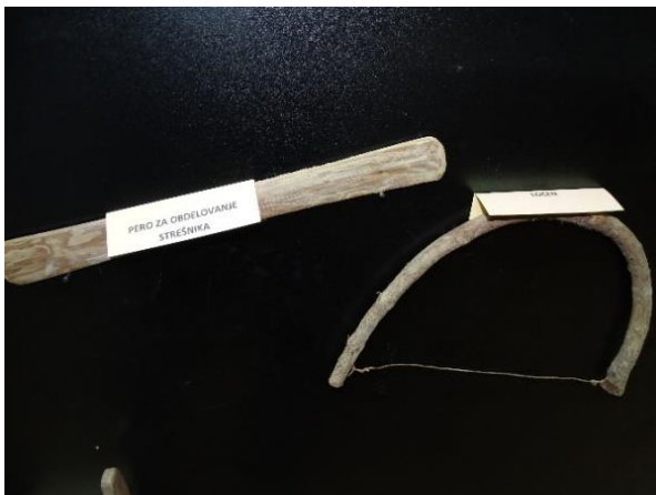
Slika 17: Pero za obdelovanje strešnika (levo) in locen (desno) (Čepin Tovornik, 2017)
