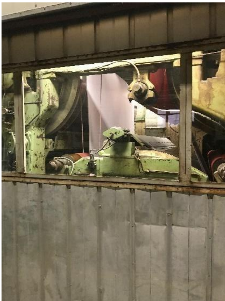
Slika 3: suhi del stiskanja, pri katerem se temperatura vrtili od 50 do 100 stopinj
