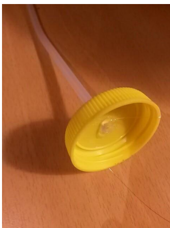
Slika 3.33: Polietilenska cev prilepljena v zamašek
