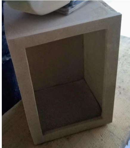
Slika 3.5: Model visoke grede s pleksi steklom
