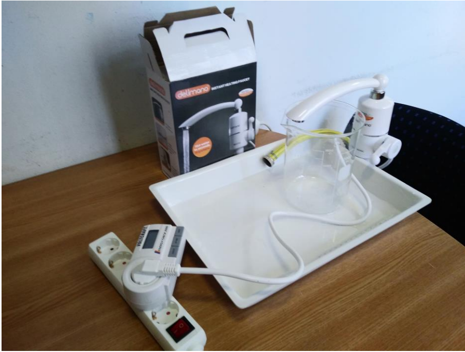
Slika 14 : Segrevanje vode s pretočno grelno pipo "Delimano"
