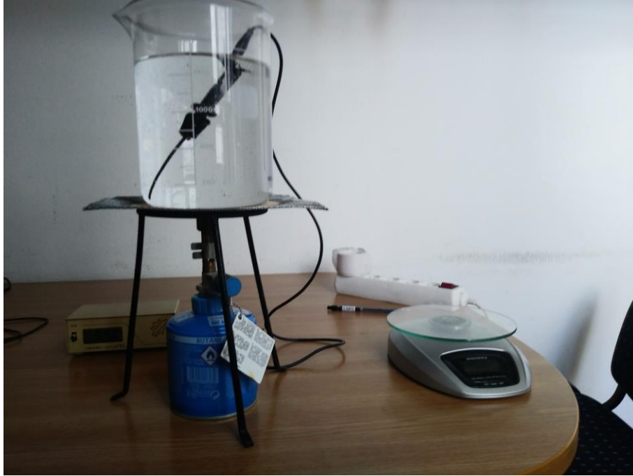
Slika 13 : Segrevanje vode s plinskim gorilnikom
