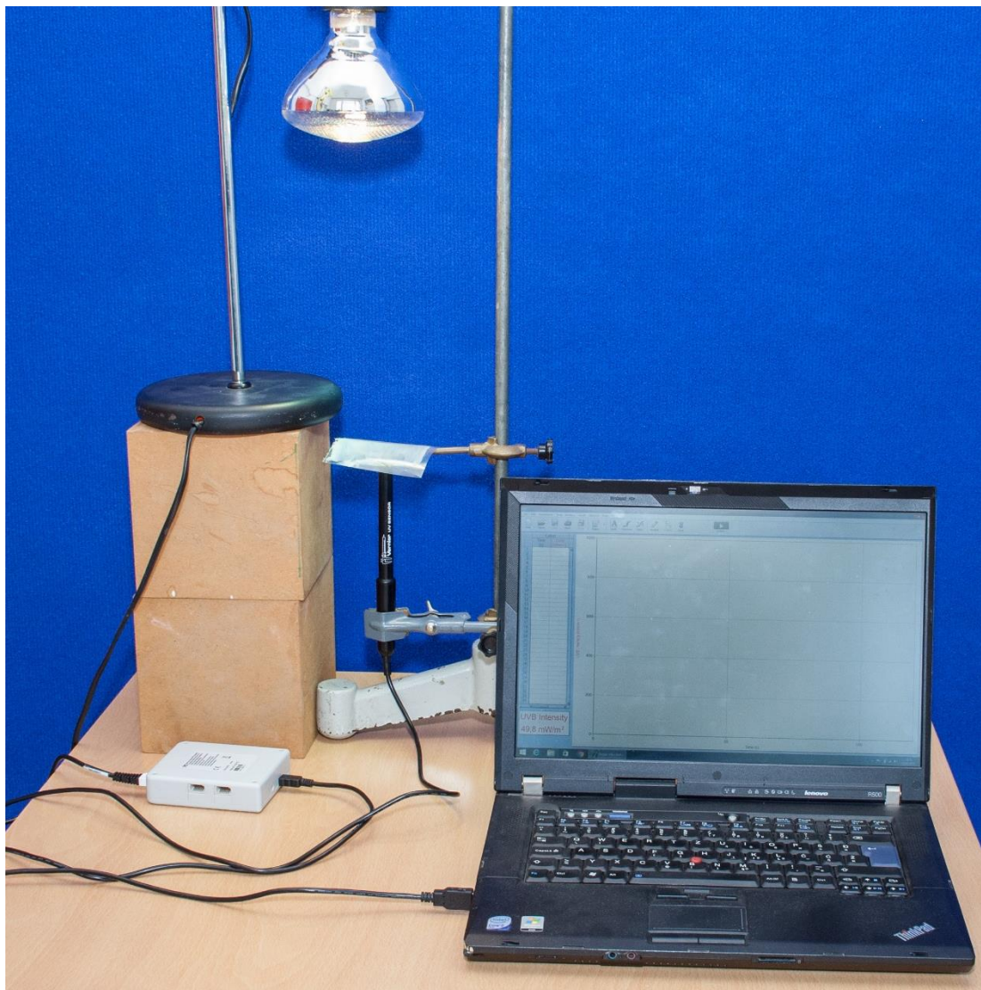
Slika 2: Izvajanje meritev z obsevanostjo 500 \text{ mW/m}^2
