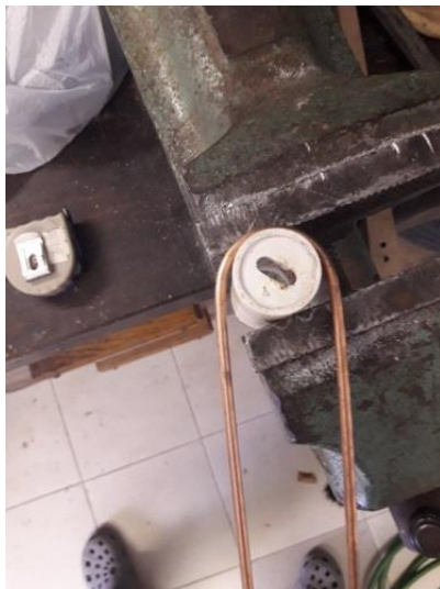
Slika 19a in 19b: Ukrivljanje žice in vrezovanje navoja. (Lasten vir.)
