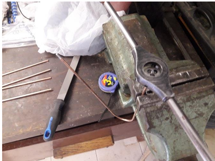
Slika 19a in 19b: Ukrivljanje žice in vrezovanje navoja. (Lasten vir.)
