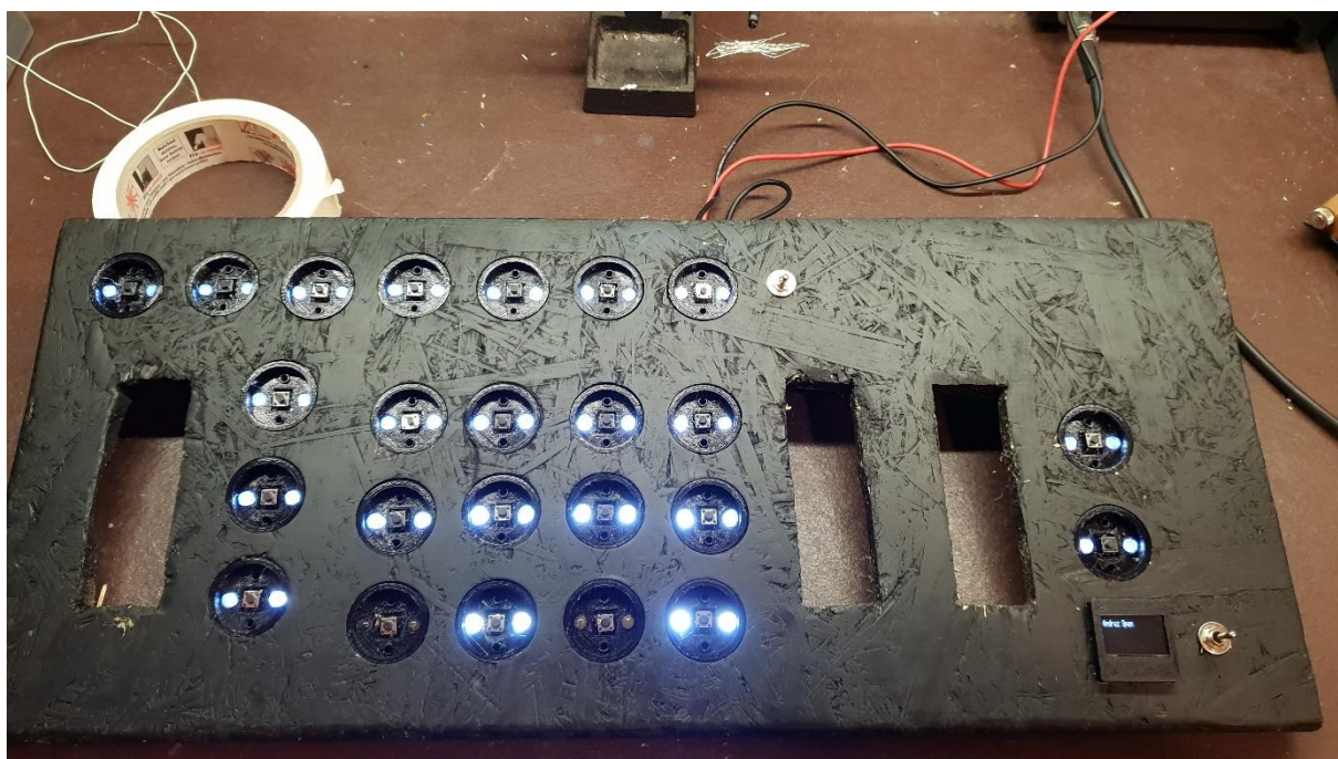
Slika 58: Testiranje LED sijalk.
