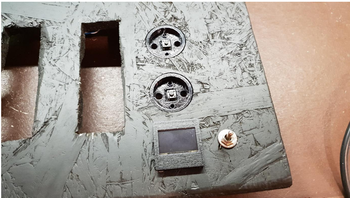
Slika 54: Vgrajena prva spodnja ohišja gumbov.
