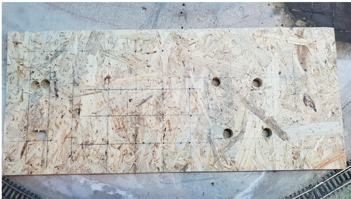
Slika 31: Izvrtane luknje za izrez z vbodno žago in pilotne luknje za forstner sveder premera 30 mm.
