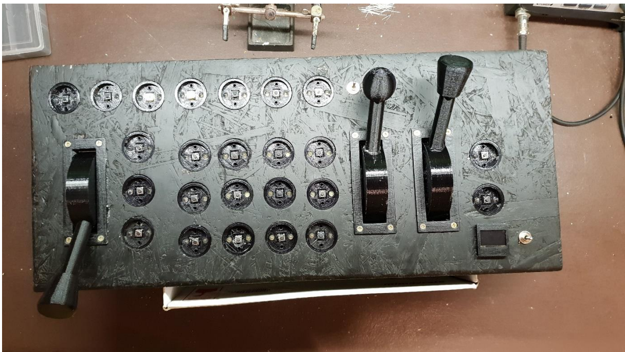
Slika 61: Vgrajeni gumbi in ročice.
