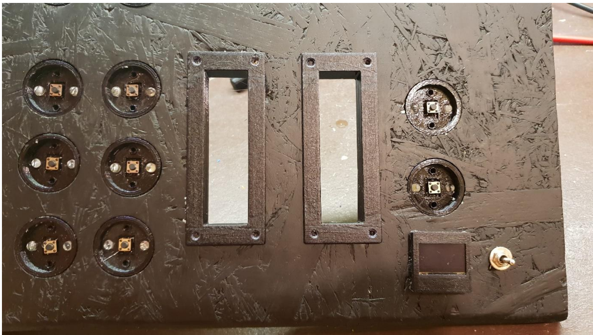
Slika 60: Vgradnja okrasnih 3D natisnjenih delov.
