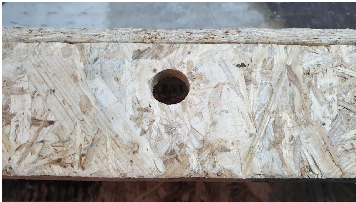
Slika 44: Izvrtana luknja za Micro USB konektor.
