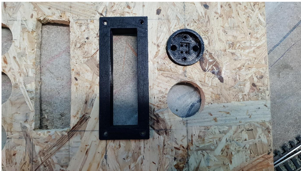
Slika 35: testiranje prileganja plastičnih komponent.
