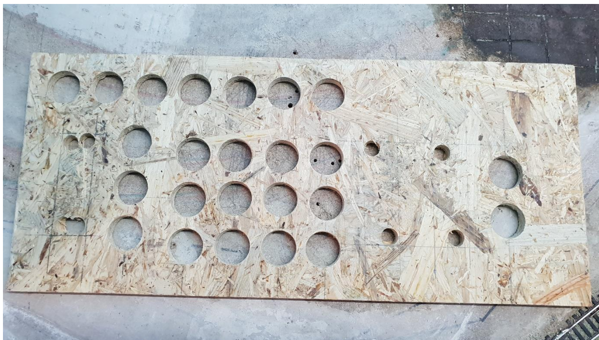
Slika 32: Izvrtane luknje premera 30 mm.
