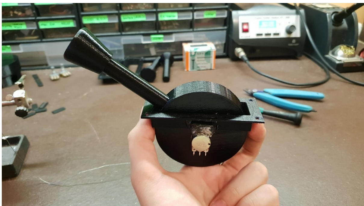
Slika 21: Testno sestavljena ročica (pred vgradnjo jo je bilo potrebno ponovno razstaviti).
