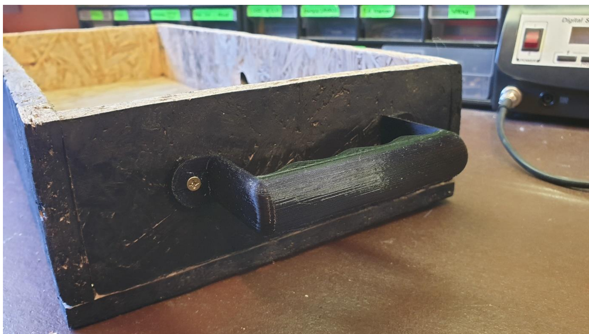
Slika 49: 3D natisnjen ročaj nameščen na spodnji del ohišja.
