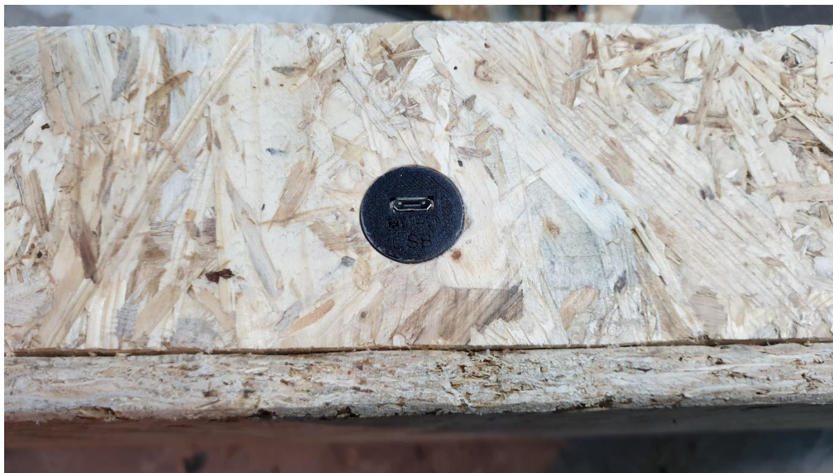
Slika 45: Vgrajen Micro USB konektor.
