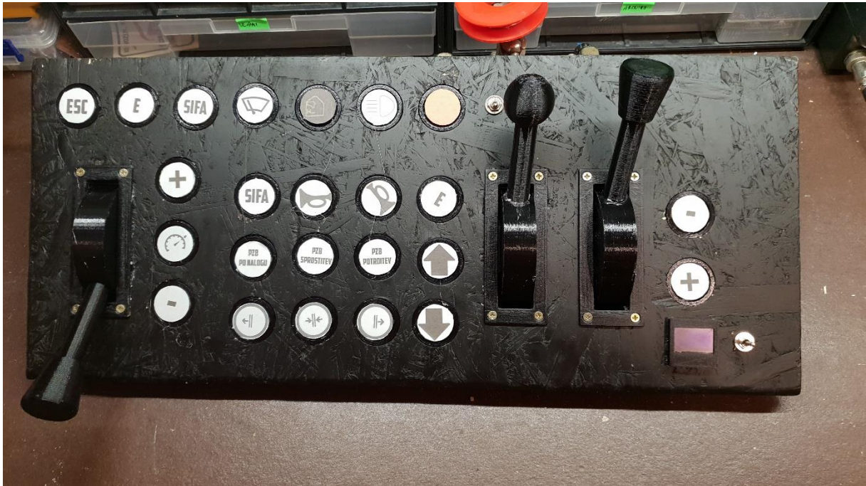
Slika 68: Sprednja stran končanega zgornjega dela ohišja kontrolne plošče.
