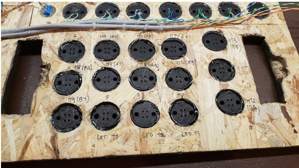
Slika 55: Vgrajena in prilepljena vsa ohišja gumbov.
