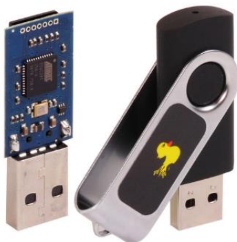
Slika 15: Notranjost in izgled USB rubber ducky-a
