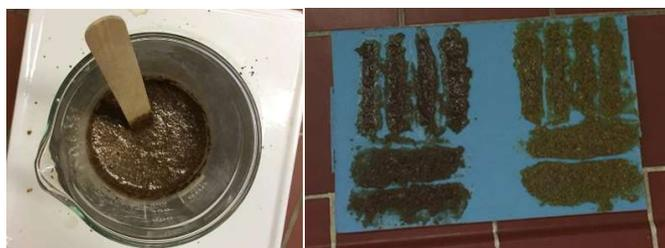
Slika 19: Primer segrevanja zmesi z listjem na kuhalniku in primer polnjenja v kalup – bioplastika s krompirjevimi olupki (desno), bioplastika s klementininimi olupki (levo)
