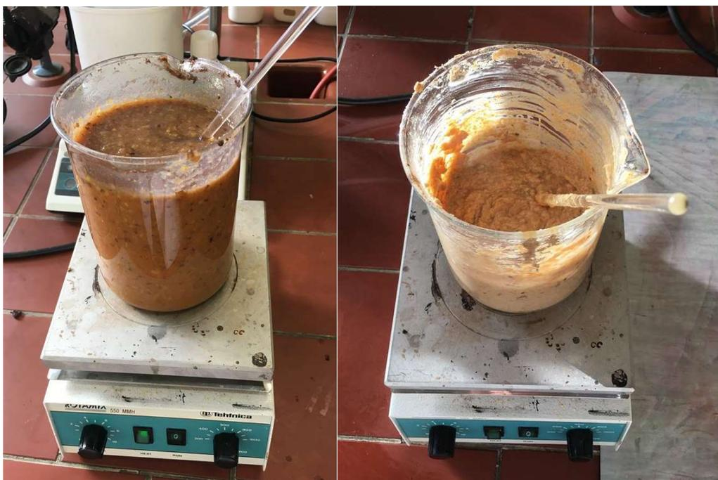
Slika 20: Izolacija škroba iz bananinih olupkov (levo) in nastajanje bioplastike (desno)
