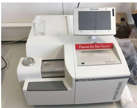
Slika 25: Termogravimetrični analizator TGA/DSC 3+ (Mettler Toledo)
