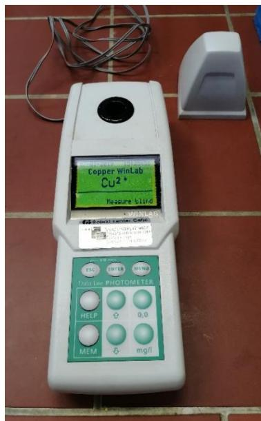
Slika 3: WinLab spektrofotometer
