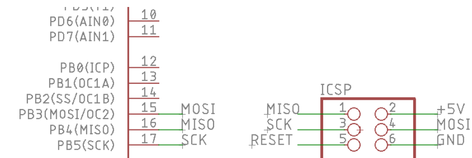
Slika 19: Shema ICSP konektorja in ATmega328p.
