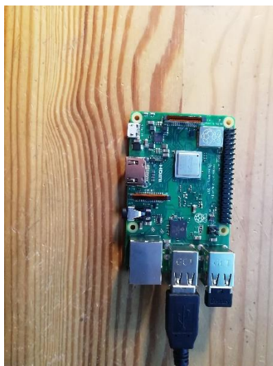
Slika 31: Priklop miške in tipkovnice na mikroračunalnik
