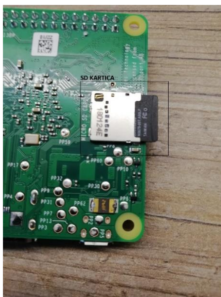
Slika 33: Priklop SD-kartice v mikroračunalnik
