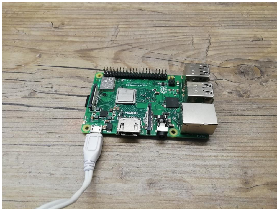
Slika 25: Priključitev napajalnika na mikroračunalnik
