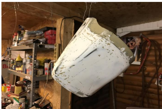
Slika 26: Pokitan zadek motocikla, pripravljen na barvanje
