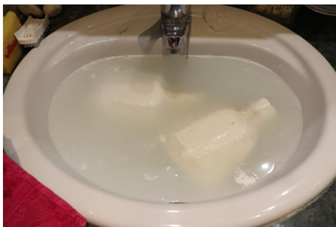
Slika 27: Čiščenje plastik v topli vodi s pralnim praškom
