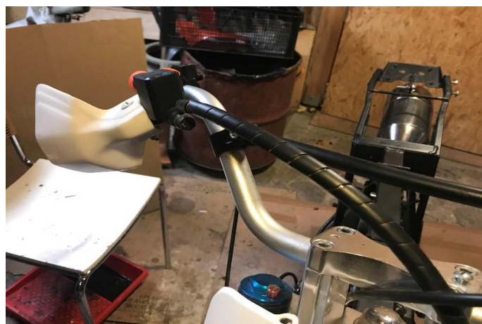
Slika 31: Zavorni kabli z črno spiralno cevjo
