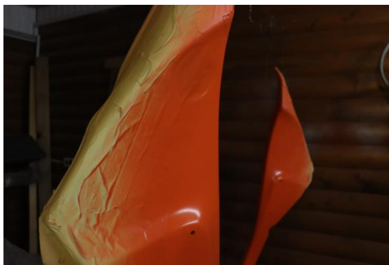
Slika 29: Pobarvana oranžna polovica in zaščitena bela polovica bočne plastike ATX 50 motocikla
