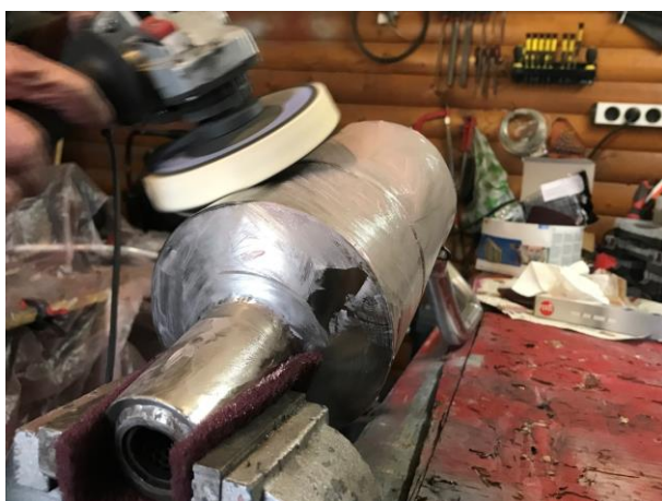
Slika 28: Poliranje zadnjega kotla izpušnega sistema
