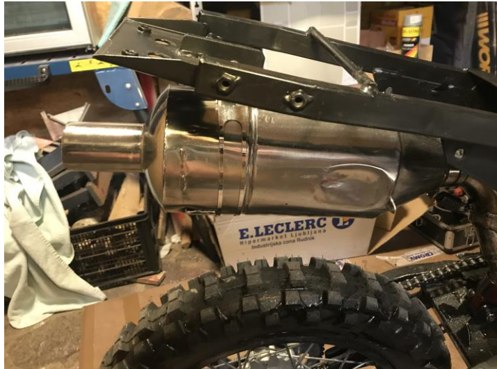
Slika 42: Zadnji kotel izpušnega sistema
