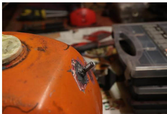
Slika 23: Vijak, ki smo ga prilepili na rezervoar s dvokomponentnim lepilom
