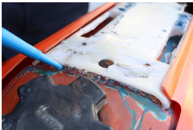
Slika 24: Lepljenje plastike za podaljšan sedež
