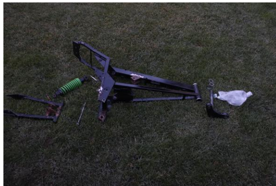
Slika 16: Okvir z originalno zadnjo roko in križem za vilice.
