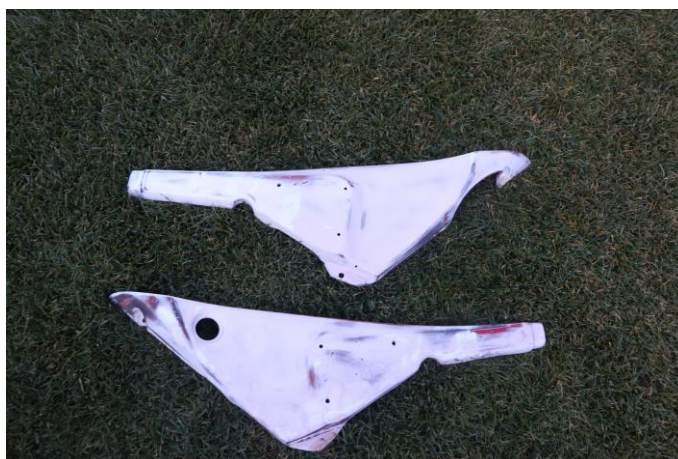
Slika 25: Zbrušene in pokitane bočne plastike motocikla ATX 50
