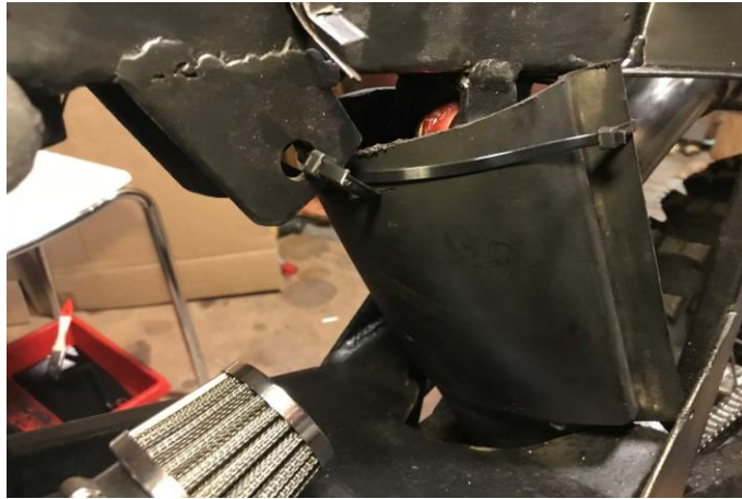
Slika 33: Zaščita za blato, pritrjena z vezicami na okvir
