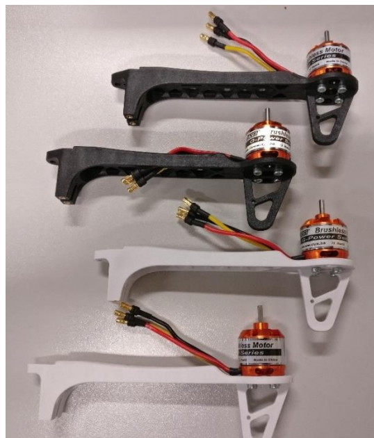
Slika 40: Motorji, pritrjeni na noge drona
