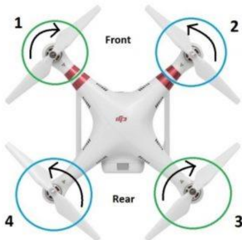
Slika 43: Smer rotacije propelerjev
