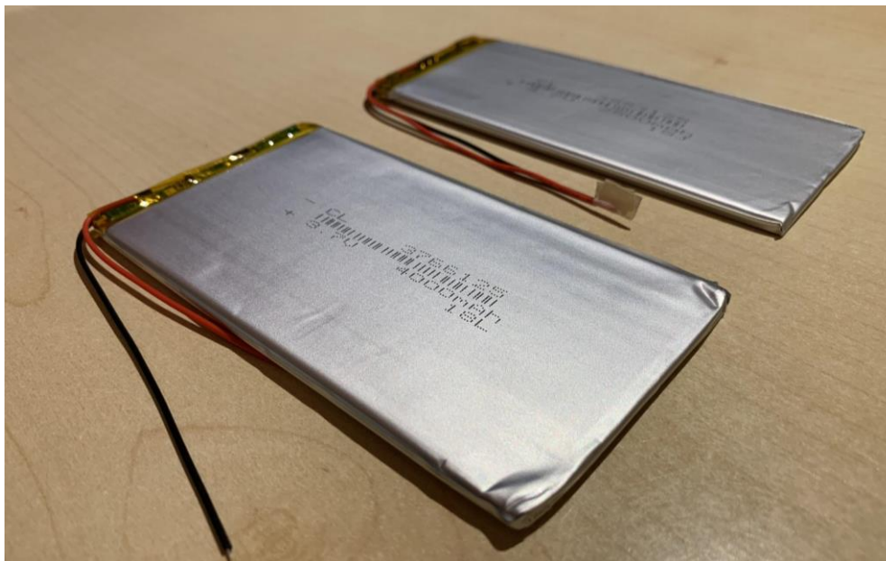
Slika 20: Tanke baterije (2500 mAh in 4000 mAh)
