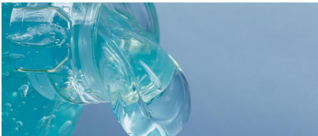
Slika 26: Gel, ki ne prevaja električnega toka
