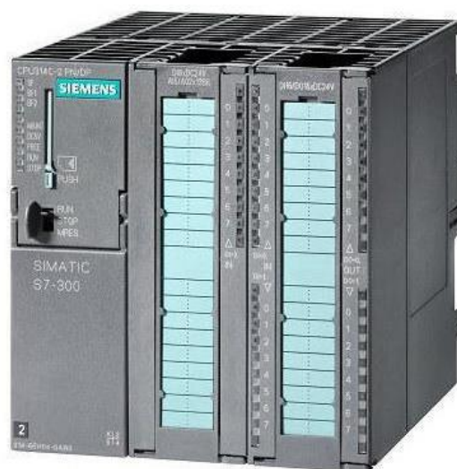
Slika 17: Modularni krmilnik Siemens S7-300
