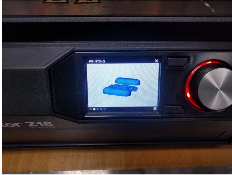
Slika 13: Predogled modela na 3D-tiskalniku (Osebni vir)
