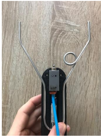
Slika 17: Montaža vzmeti (Osebni vir)
