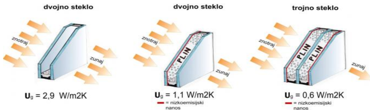
Slika 3: Prikaz razlike med dvoslojno in troslojno zasteklitvijo, z nizkoemisijским nanosom in brez njega [21]
