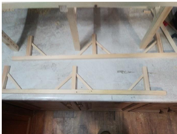
Slika 24: Pripravljeni nosilci ostrešja (koza) [24]
