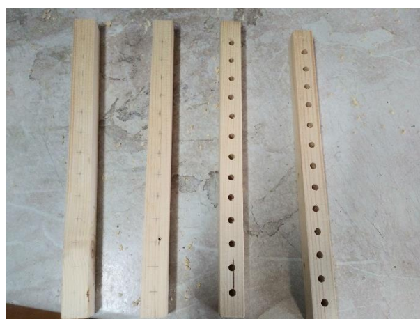
Slika 20: Izdelani stebri kozolca z izvrtanimi luknjami za rante [20]
