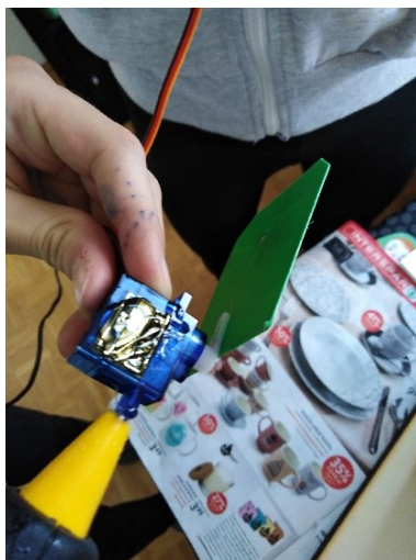
Slika 23: Priprava servo motorčka z zapornico za namestitev na ohišje
