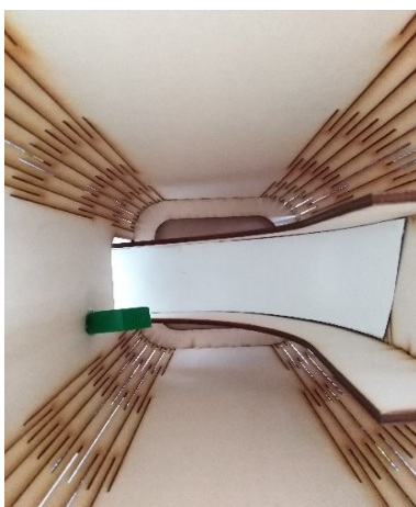
Slika 25: Namestitev tobogana z drsno površino in priprava za namestitev servo motorčka
