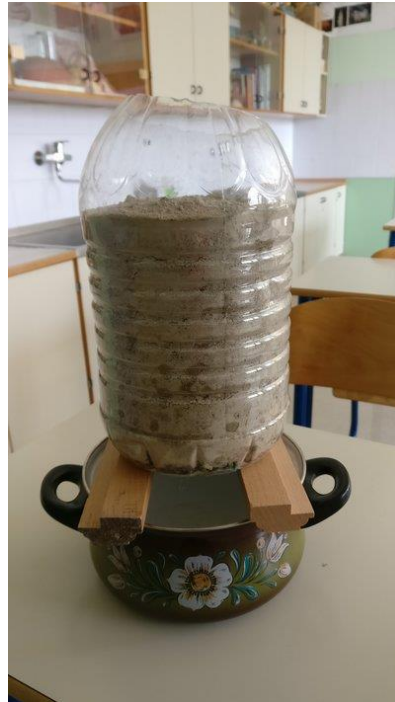
Slika 3: Aparatura za pridobivanje lužine iz pepela
