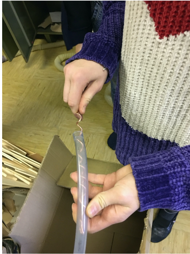
Slika 33: Namestitev izdelane LEGI BAKRENKE v prozorno cev tuša
