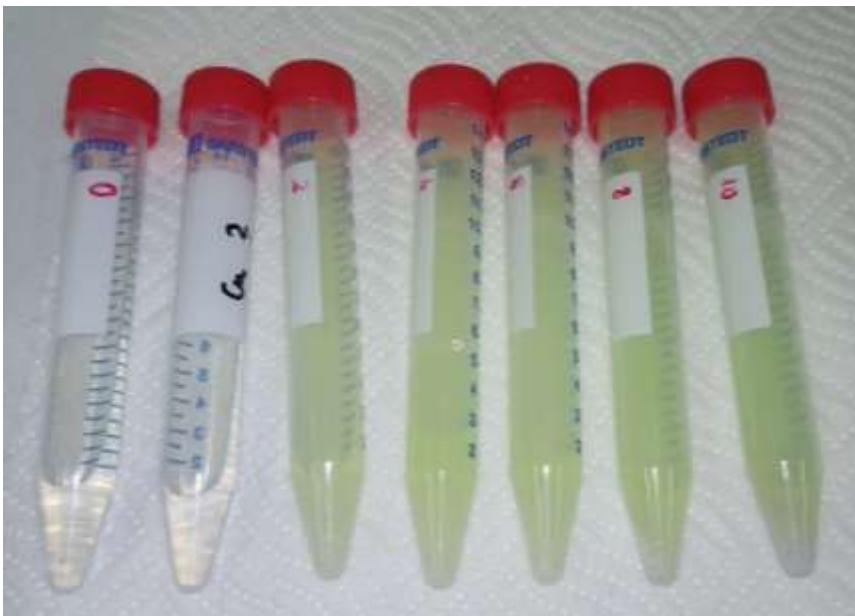
Slika 29: Določitev vsebnosti bakra v neznanem vzorcu na osnovi primerjave kontrastov na barvni lestvici. Koncentracija bakrovih ionov je nižja, kot jo je možno določiti z našo metodo. Foto: Klara Klinc.
