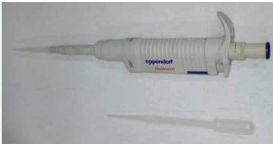
Slika 13: Pipeta, ki smo jo uporabljali za vnos manjših volumnov raztopin v centrifugirke, in kapalka, ki je manj natančna. Foto: Bojan Rebernak.
