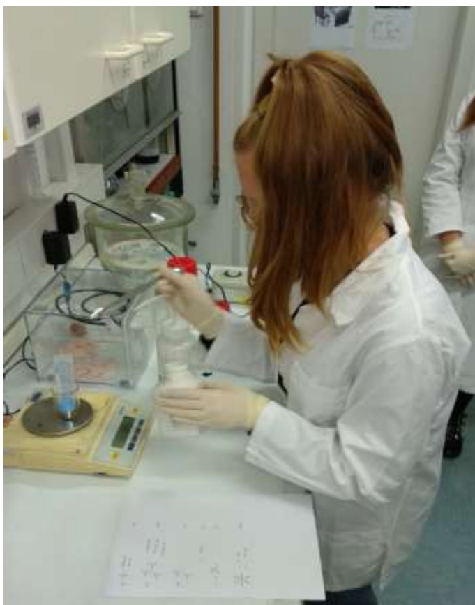
Slika 14: Tehtanje 7,81 g bakrove soli na precizni tehtnici. Foto: Bojan Rebernak.
