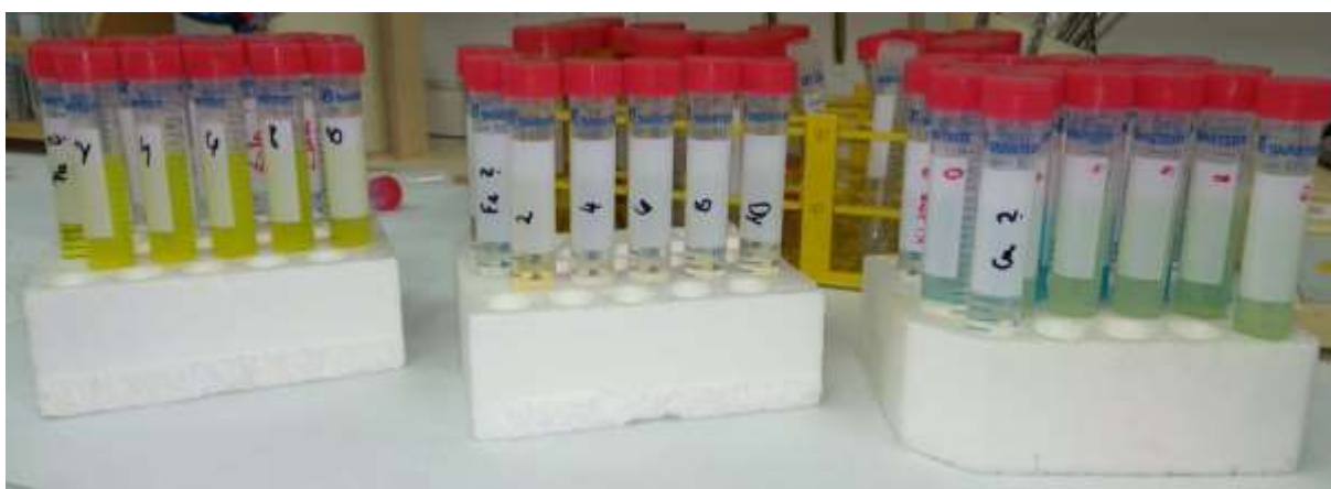
Slika 34: Končni rezultat raziskave. Barvne lestvice s primerjavo treh neznanih vzorcev v centrifugirkah. Foto: Bojan Rebernak.
