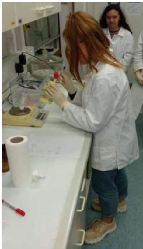
Slika 18: Tehtanje 5 g kalijevega tiocianata na precizni tehtnici. Foto: Bojan Rebernak.
