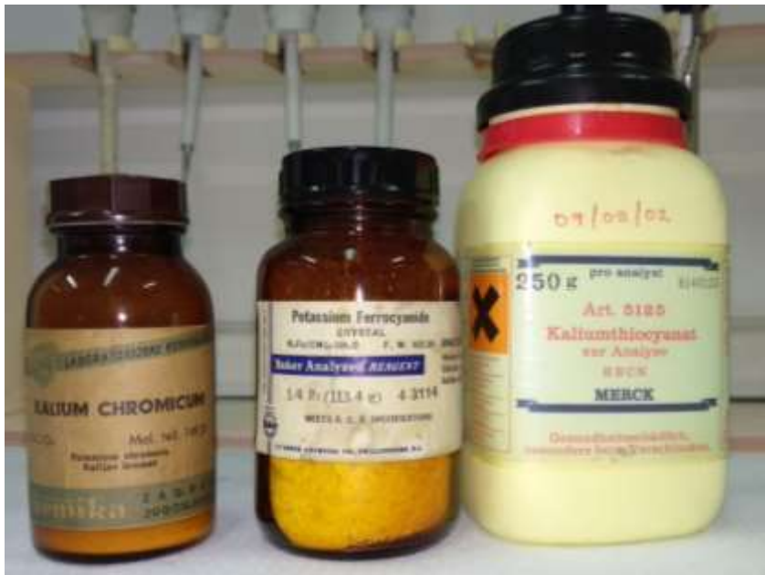
Slika 17: Trije reagenti: kalijev kromat(VI) ( K_2CrO_4 ), kalijev heksacianoferrat(II) ( K_4[Fe(CN)_6] \cdot 3H_2O ) in kalijev tiocianat (KSCN). Foto: Bojan Rebernak.
