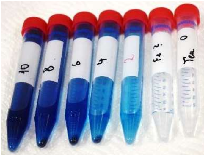
Slika 28: Določitev vsebnosti železovih ionov v neznanem vzorcu na osnovi primerjave barv umeritvene krivulje. Foto: Tea Horvatič.
