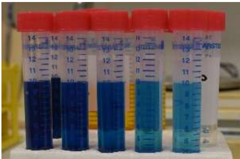
Slika 25: Stokrat razredčena raztopina železove soli, reagenta kalijevega heksacianoferata in vode. V tretjem poskusu je barvna lestvica bila pripravljena za analizo neznanega vzorca. Foto: Tea Horvatič.
