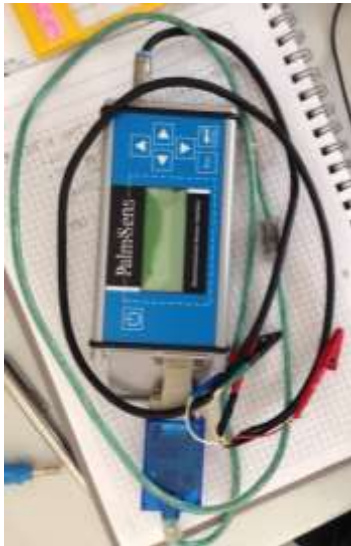
Slika 10: Aparatura za elektroanalitiko. Foto: Vasko Jovanovski.
