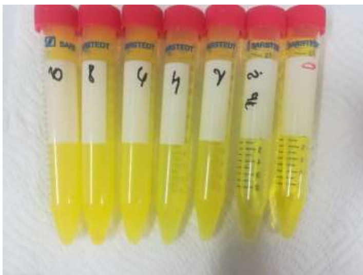
Slika 27: Določitev vsebnosti svinčevih ionov v neznanem vzorcu na osnovi primerjave barv barvne lestvice. Ugotovili smo, da je v neznanem vzorcu svinca približno 0,1 %. Foto: Zala Ratej.
