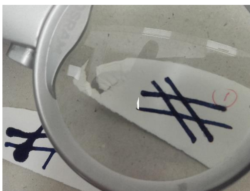
Slika 24: Sled črnila na klejenem vzorcu [osebni arhiv]
