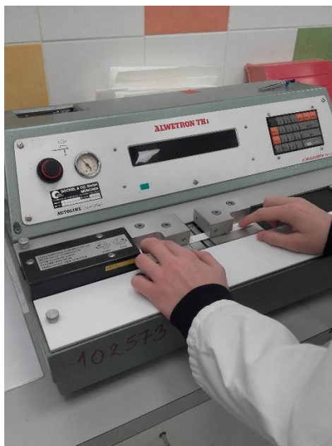
Slika 15: Dinamometer, s katerim merimo utržno vrednost papirja [osebni arhiv]
