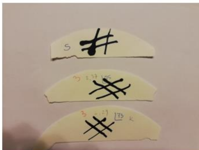
Slika 25: Primerjava testa s črnilom pri različnih vzorcih [osebni arhiv]
