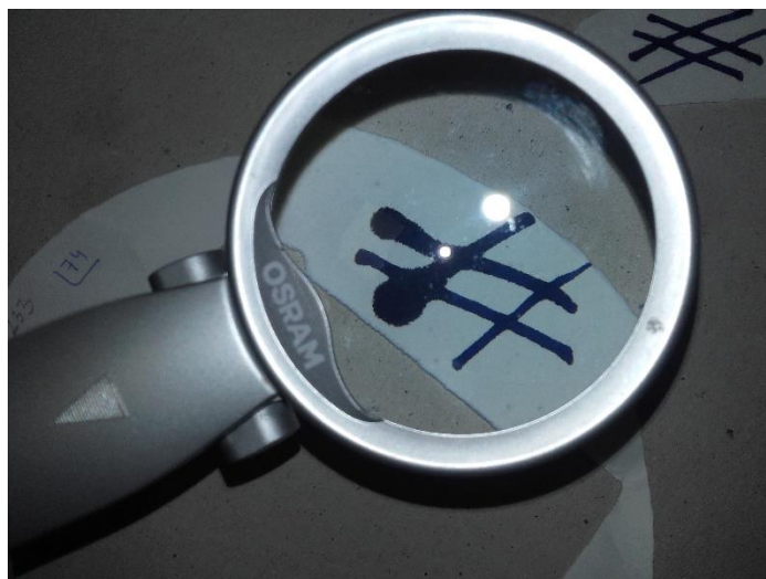
Slika 23: Sled črnila na neklejenem vzorcu [osebni arhiv]
