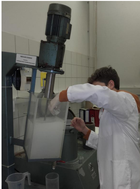
Slika 8: Dodajanje klejiva v celulozno zmes [osebni arhiv]
