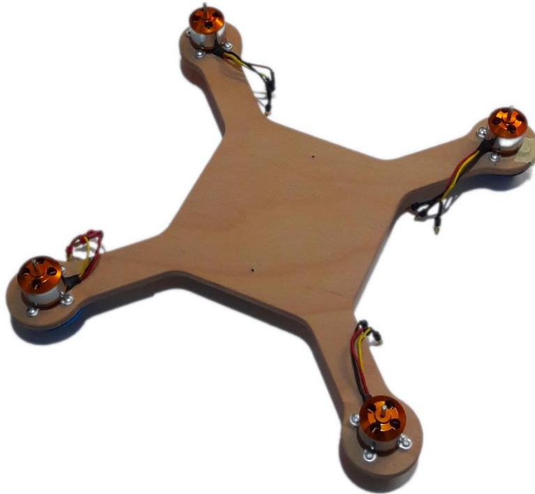
Slika 13: Izdelano ogrodje štirikopterja s pritrjenimi elektromotorji
