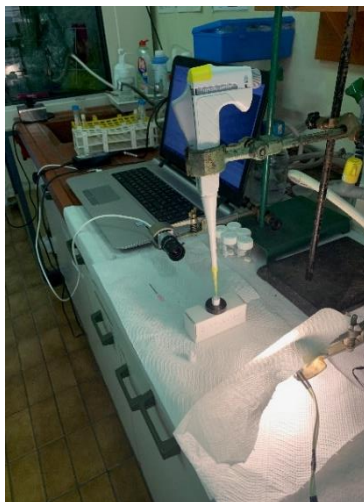
Slika 8: Aparatura za merjenje kontaktnih kotov
