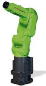
Slika 2: Kolaborativni robot Fanuc
