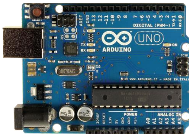
Slika 23: Mikrokontroler Arduino UNO REV3
