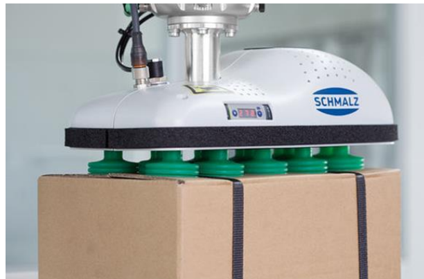
Slika 7: Vakuumsko prijemalo Schmalz
