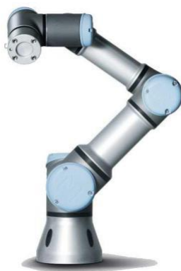
Slika 5: Kolaborativni robot Universal Robots UR3
