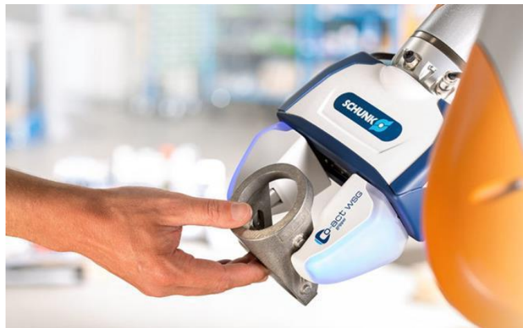
Slika 6: Električno kolaborativno prijemalo Schunk
