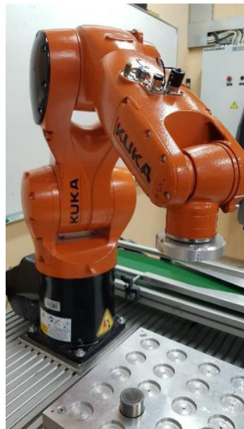
Slika 1: Robotski mehanizem Kuka KR6 R700 sixx
