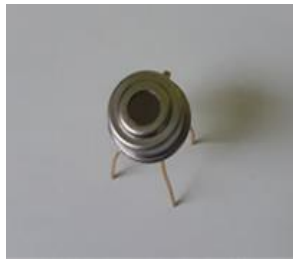
Slika 19: IR temperaturni senzor MLX 90614
