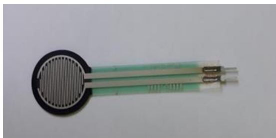
Slika 21: Senzor za merjenje sile na dotik
