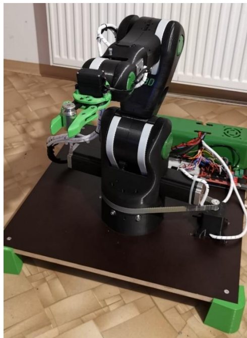
Slika 41: Merjenje nosilnosti robotske roke
