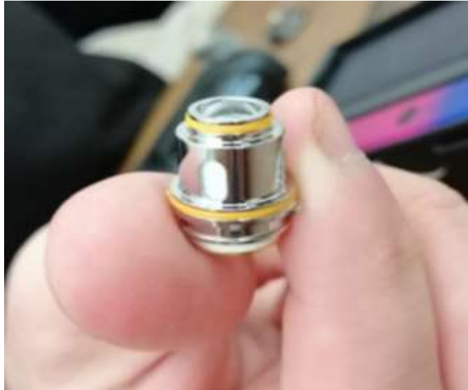
Slika 13: Grelna glava z vato, kjer se e-tekočina upari
