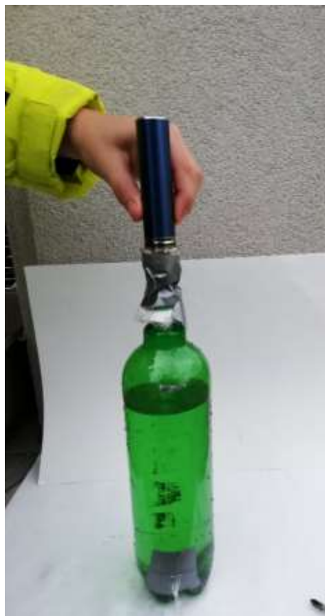
Slika 22: Poskus simuliranega kajenja elektronske cigarete
