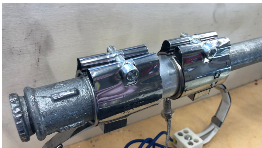
Slika 21: Pritrditev grelcev (Vir: Osebni)
