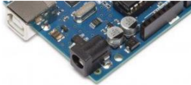
Slika 12: Črn priključek za delovanje krmilnika Arduino UNO (Vir: http://mladiraziskovalci.scv.si/ogled?id=1608 )
