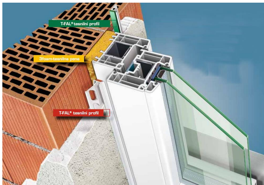
Slika 44: Prikaz ene od možnosti 3-slojne vgradnje s tesnilnimi profili
