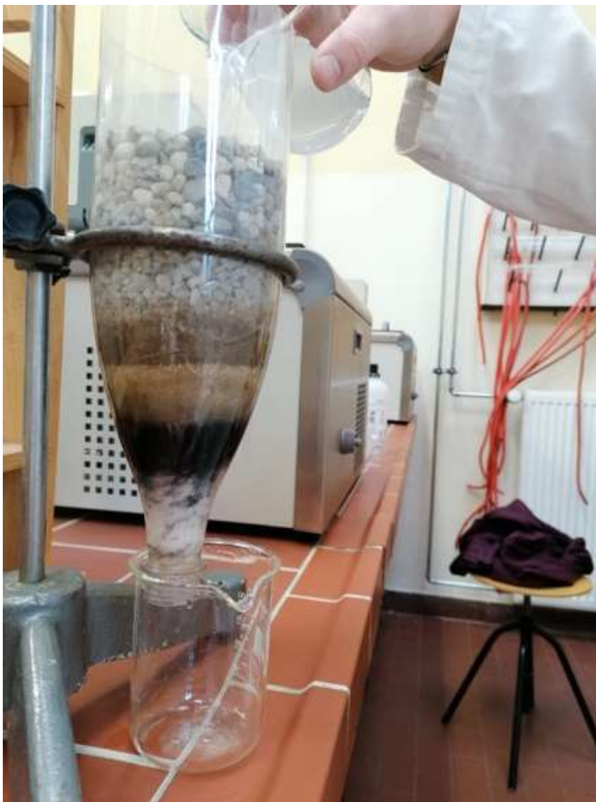
Slika 9: Peščeni filter vir: lasten; 6.3.2020
