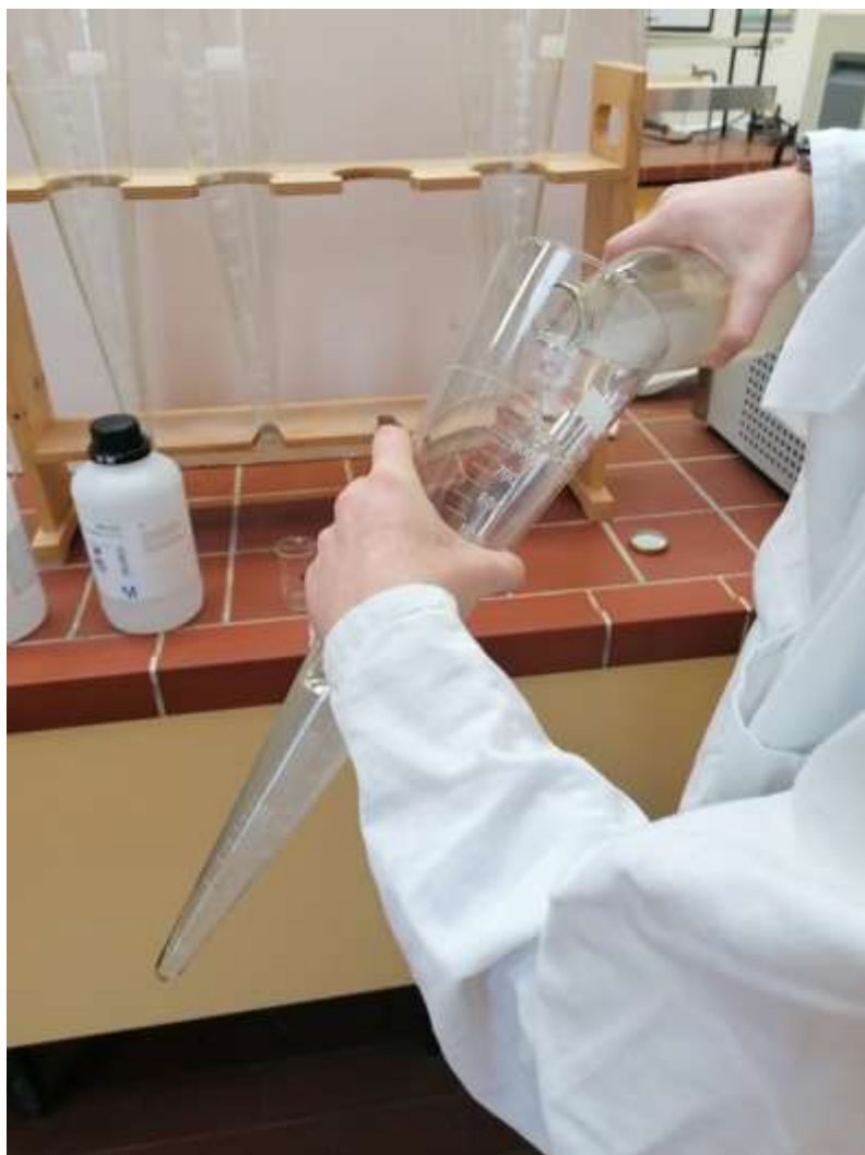
Slika 6: Nalivanje vzorca v Imhoffov lij, vir: lasten; 6.3.2020
