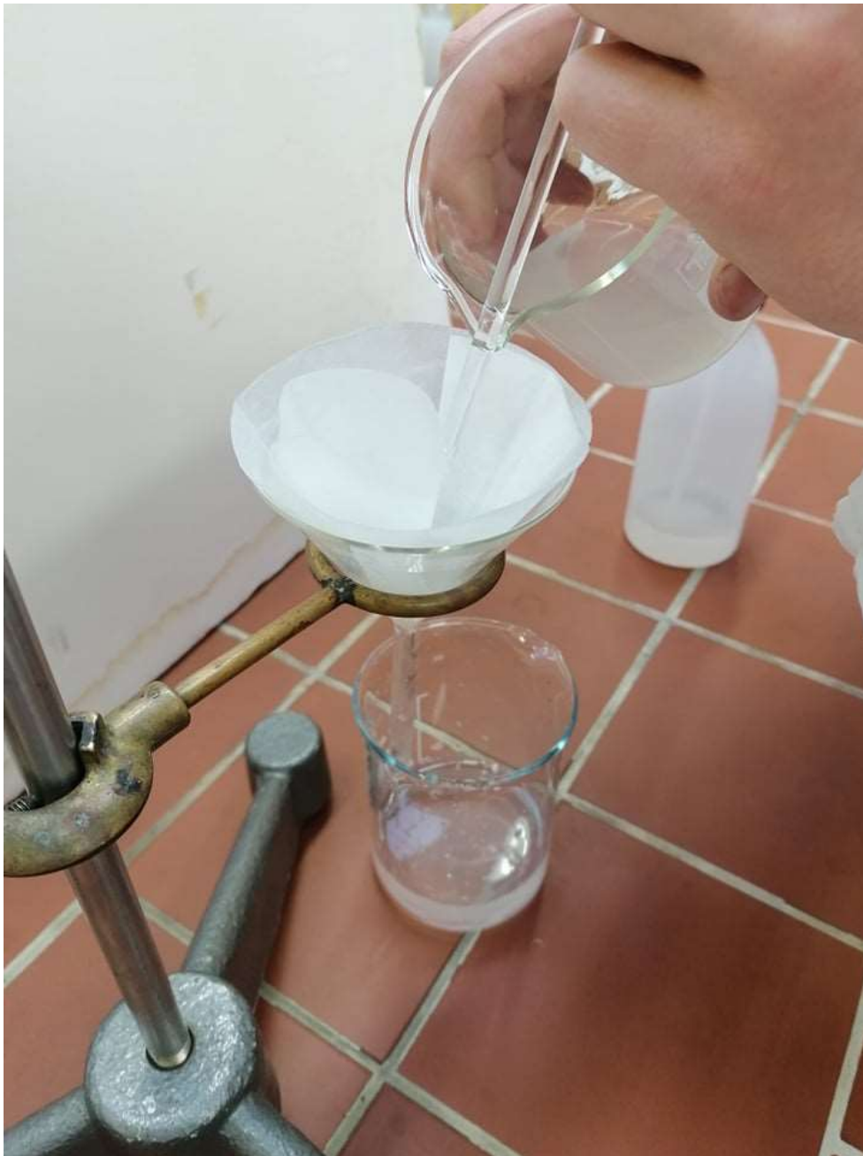
Slika 8: Vlivanje vzorca skozi filtrirni papir vir: lasten; 6.3.2020
