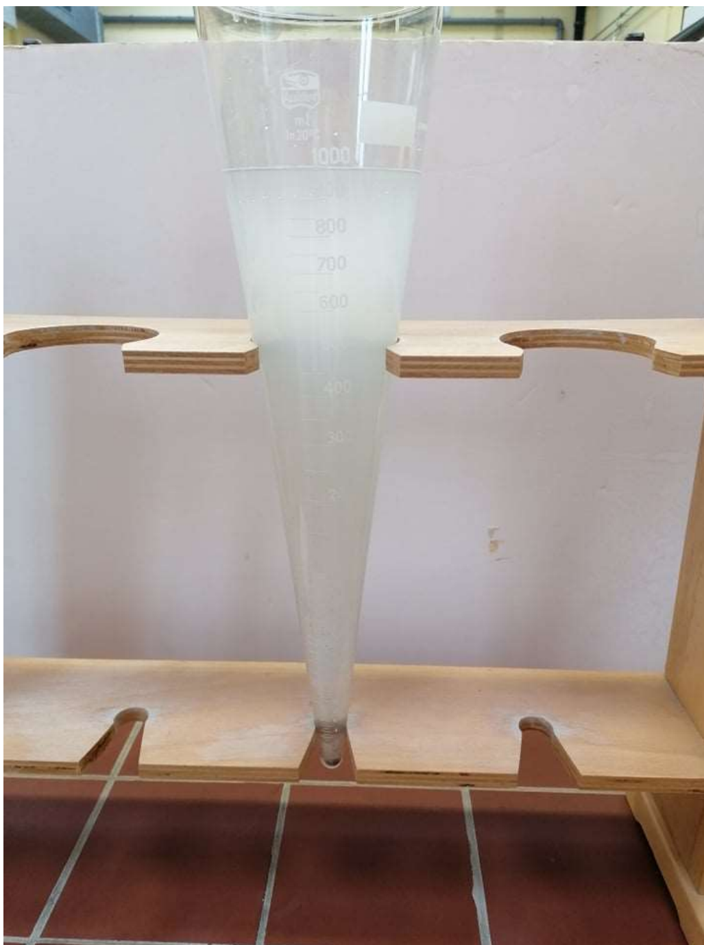
Slika 7: Usedanje trdnih delcev v vodi vir: lasten; 6.3.2020
