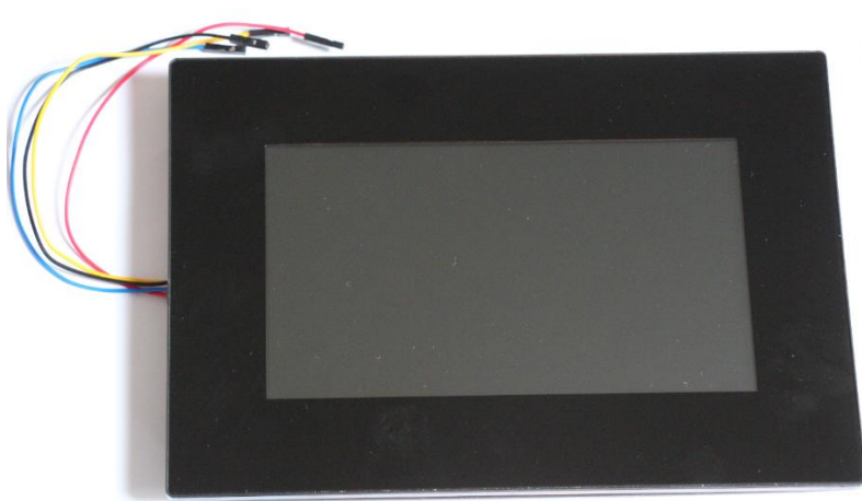
Slika 3: Zaslon na dotik Nextion
