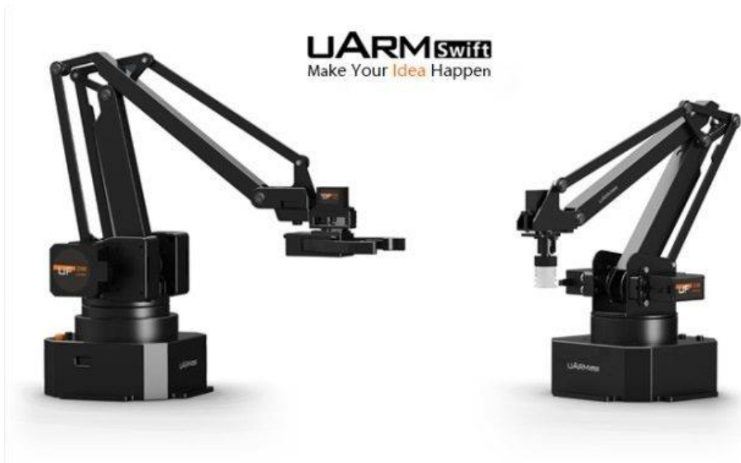
Slika 26: Levo je roka s koračnimi motorji, desno pa z RC-servo motorji
