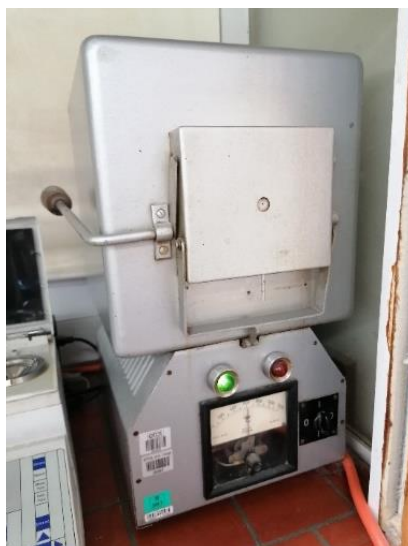
Slika 22: Električna žarilna peč
