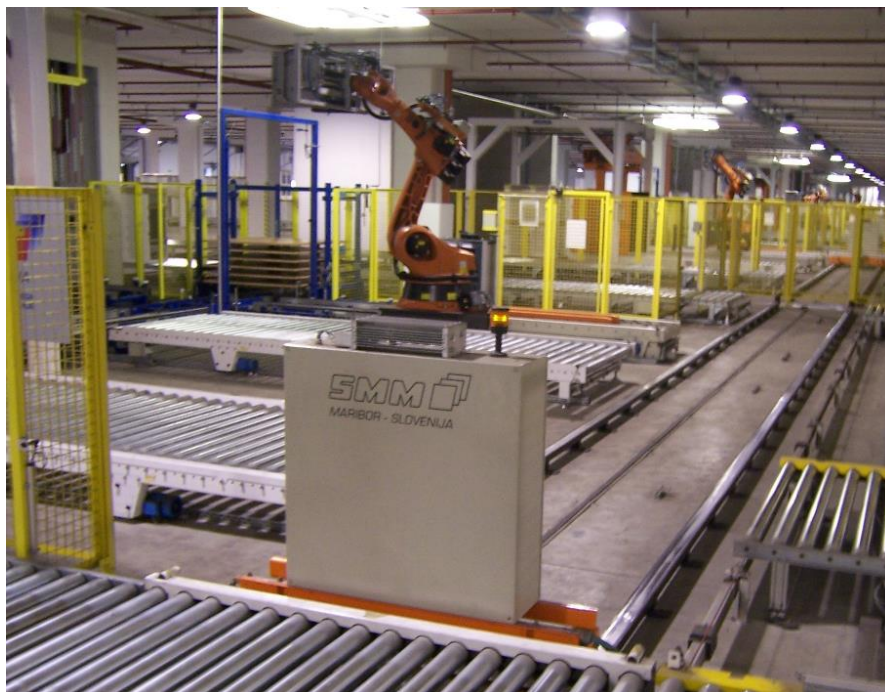
Slika št. 7: Avtomatizirana manipulacija v skladiščnem sistemu, Gorenje Velenje
