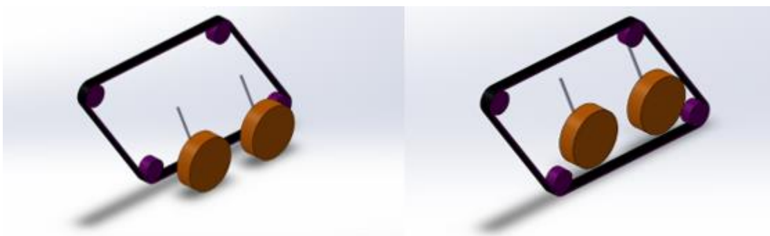
Slika 12: Idejna zasnova za spuščanje koles in gosenic
