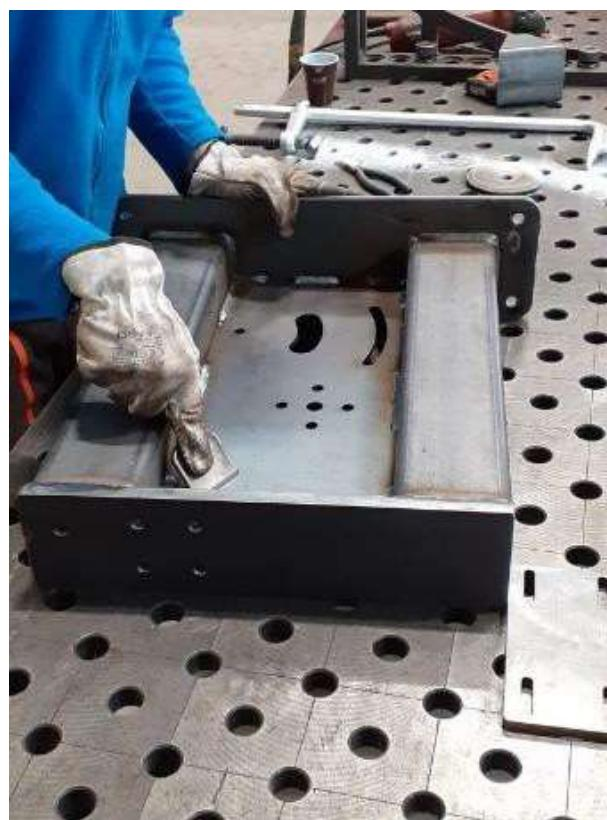
Slika 27: Čiščenje površine po varjenju
