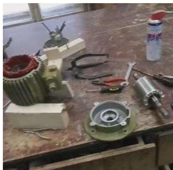
*Slika 16: Razstavljen elektromotor in menjava ležajev*
