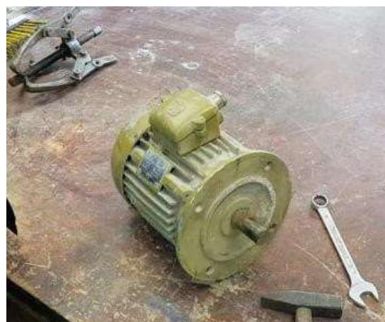
*Slika 18: Sestavljen in očiščen elektromotor*
