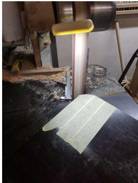
Slika 45: Brušenje robov mize
