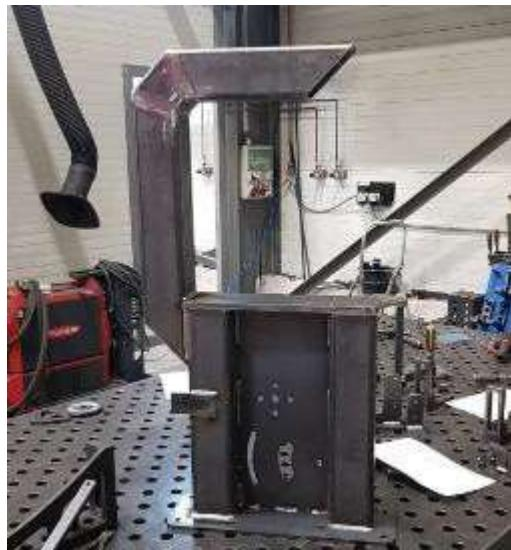
Slika 28: Zvarjena osnovna konstrukcija tračne žage
