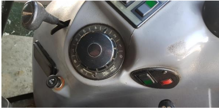
Slika 8: Potenciometer za nastavljanje spodnje meje spusta
