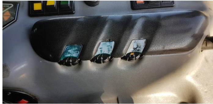
Slika 4: Prikaz treh potenciometrov v kabini
