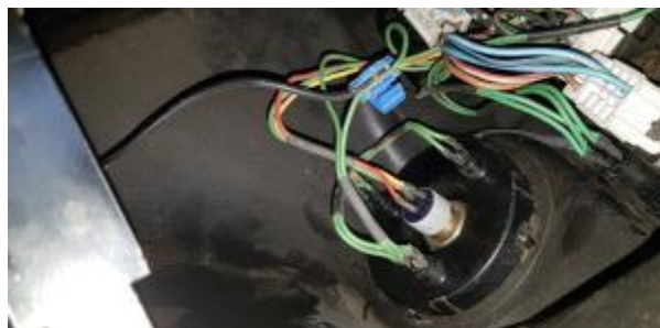
Slika 9: Potenciometer PE30 v vezavi
