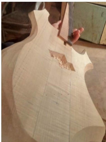
Slika 19: Preverjanje utora magnetov
