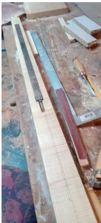
Slika 15: Vstavljanje torzijske palice
