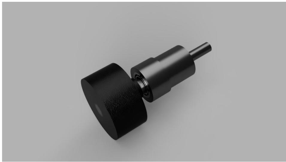
Slika 38: Pogonsko kolo z osovinama-3D model
