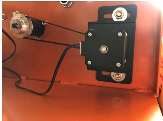
Slika 37: Nosilec za gonilni motor z motorjem
