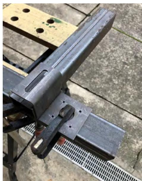
Slika 36: Priprava na varjenje nosilca za gonilni motor
