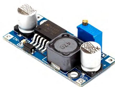
Slika 18: LM 2596 DC-DC pretvornik
