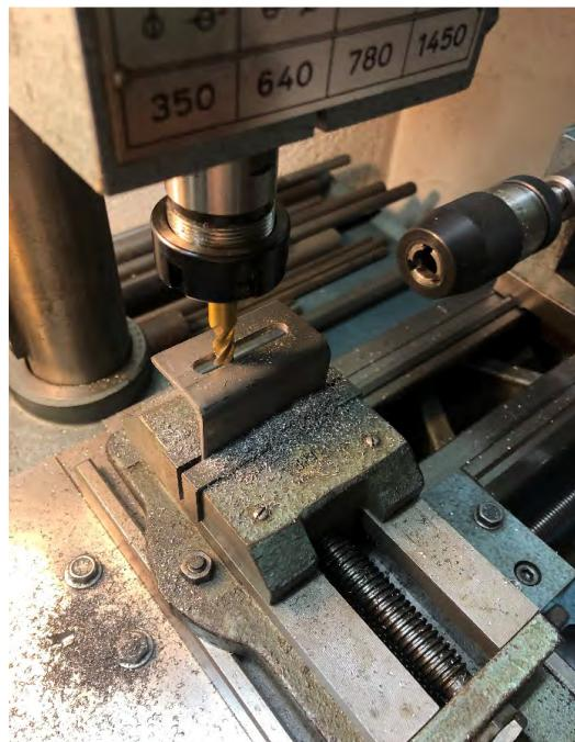
Slika 35: Rezkanje izreza za vodilo nosilca za zgornje kolo
