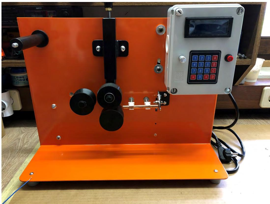
Slika 1: Naprava za rezanje žice
