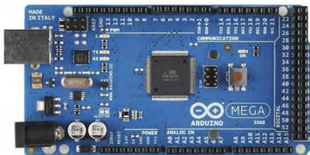
Slika 12: Plošča arduino MEGA
