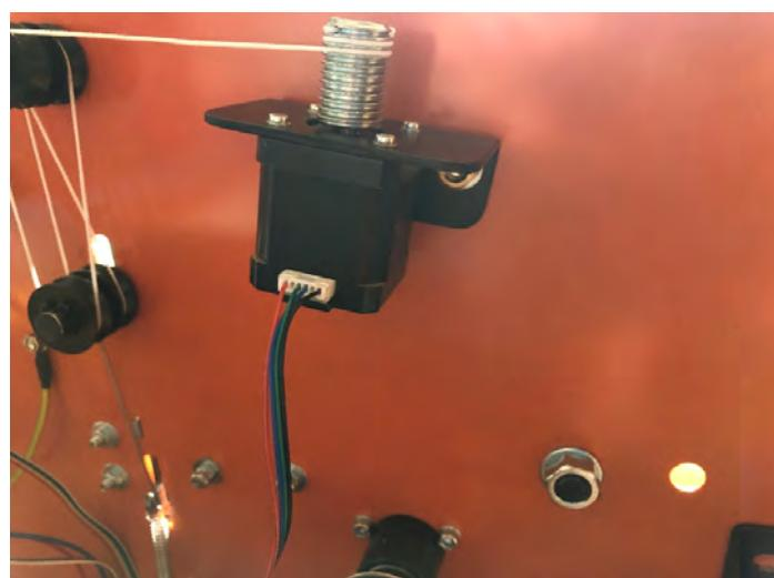
Slika 34: Nosilec motorja za rezanje z motorjem
