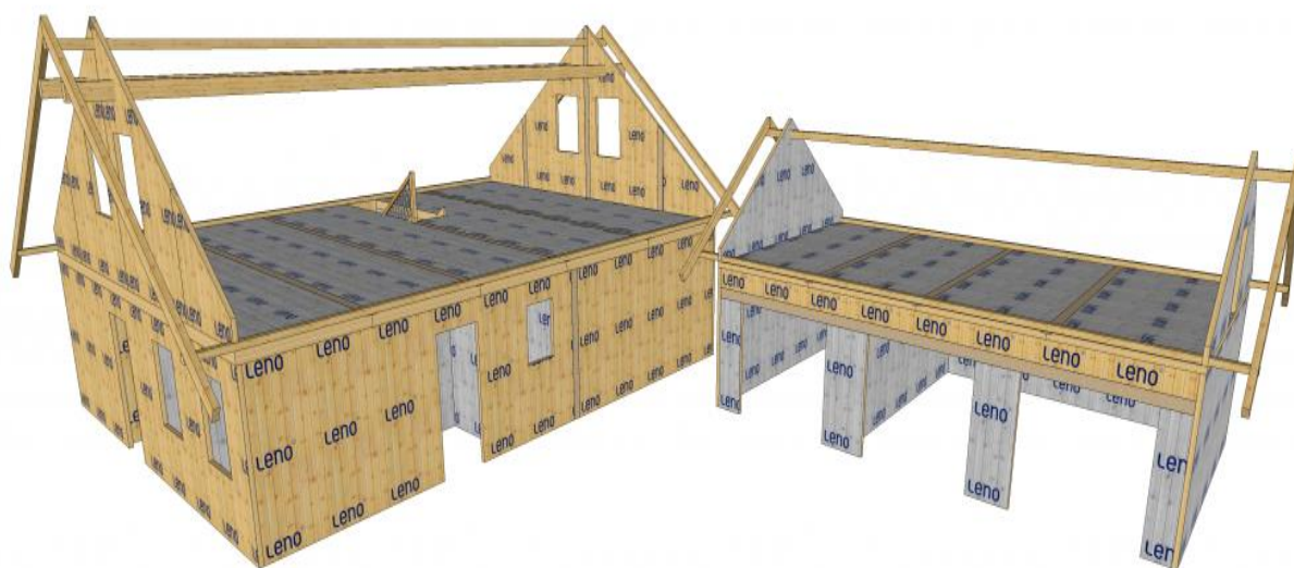
Slika 8: Računalniška ponazoritev gradnje s križno lepljenimi ploščami
