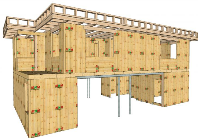
Slika 7: Računalniška ponazoritev gradnje s križno lepljenimi ploščami
